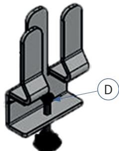
Colocar la pieza de presión [D] sobre la cabeza esférica del tornillo de presión [C] y presionar hasta que encastre.
