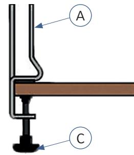
Colocar la abrazadera de mesa soni FIX CLAMP [A] en el borde del escritorio y ajustar con el tornillo de presión [C].
